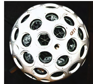
Der Satellit GFZ-1 wurde am Deutschen GeoForschungsZentrum in Potsdam entwickelt. Gut zu erkennen sind die Reflektoren (Spiegelflächen), die gleichmäßig verteilt in das Grundgerüst eingelassen sind. Quelle: GFZ Potsdam
